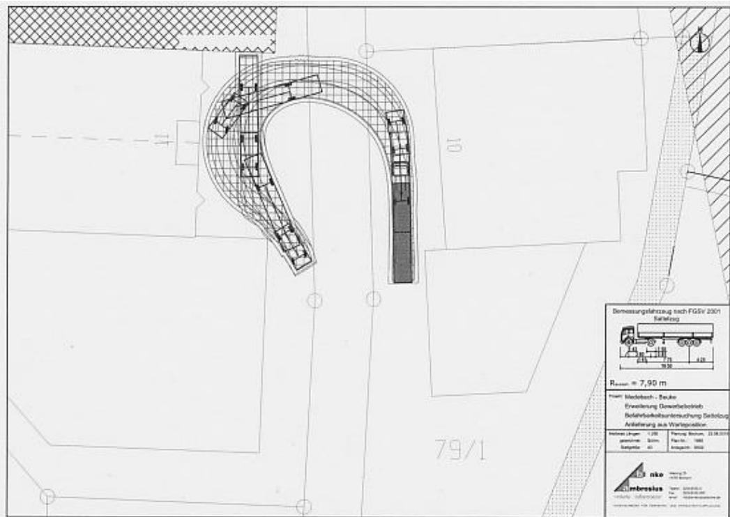
Abb. 63 - Befahrbarkeitsuntersuchung Anlieferung mit ‚Sattelzug‘ aus der Warteposition
