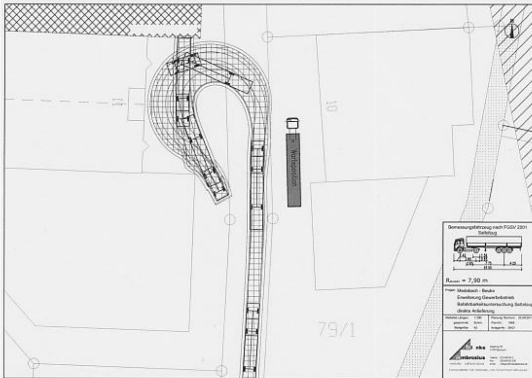
Abb 62 - Befahrbarkeitsuntersuchung ‚Sattelzug‘ in direkter Anlieferung
