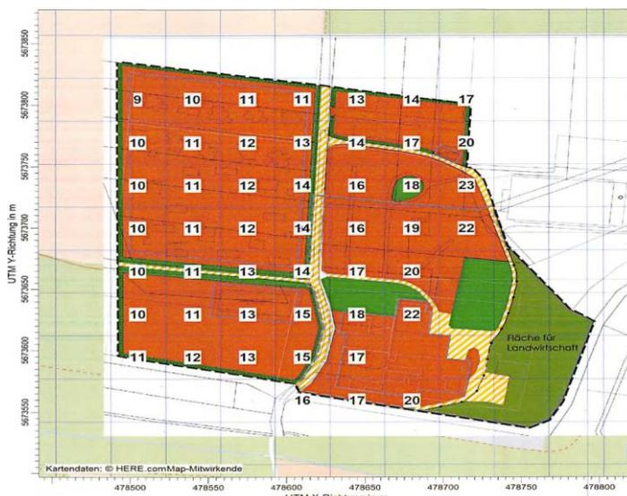
Abb. 26 – Gesamtbelastung des Plangebietes durch die Tierhaltungsanlagen Schmidt und Schreiber sowie durch die Biogasanlage Schmidt in % der Jahresstunden (Seitenlänge 35 m) – räumliche Ausdehnung des Gutachtens auch auf die zukünftig geplanten SO-Flächen westlich des ‚Hasenkammers‘
